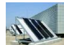
屋外太陽電池 モジュール試験設備
